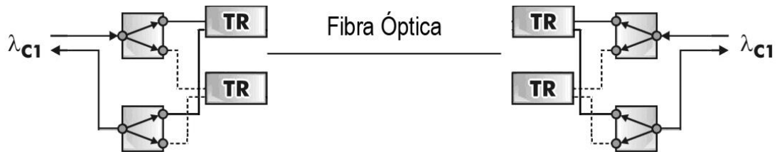
Exemplo de sistema com proteção de transponders
